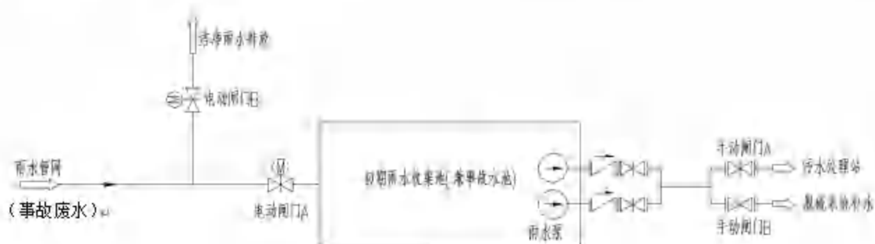
图 6.6-1 闸阀控制示意流程图
